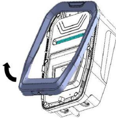
4. Retirez les six vis de la partie avant à l'aide d'un tournevis et retirez la partie avant du boîtier.
