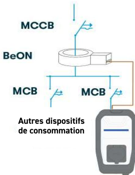
Celui-ci doit être connecté au port BOR5, sur le circuit imprimé du point de recharge.
